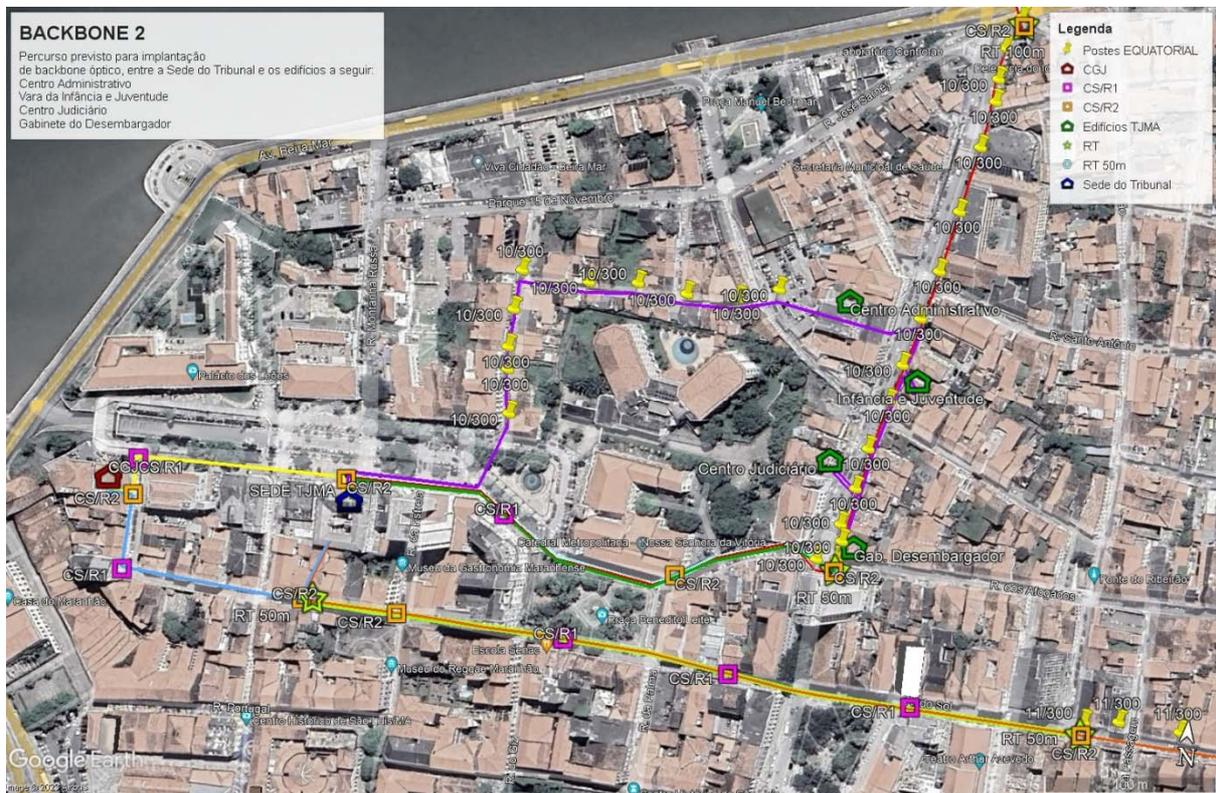
**Figura 02 – Percurso Previsto do Anel / Backbone Óptico 2. Interligando o prédio sede do TJMA e o Centro Administrativo com as Derivações.**
