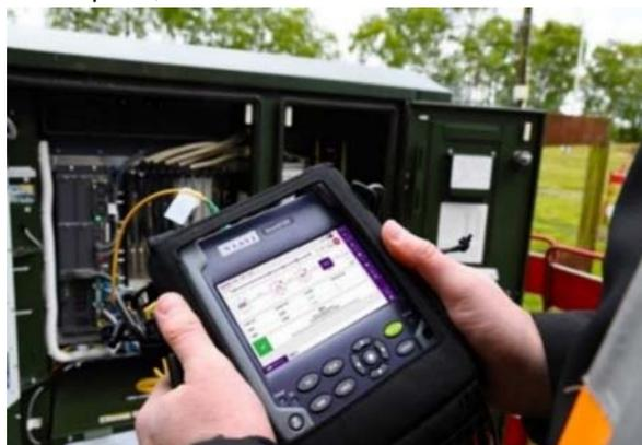
Figura 7: Certificação de fibras ópticas
