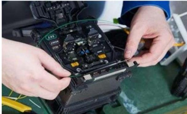
Figura 6: Fusão de fibras ópticas
