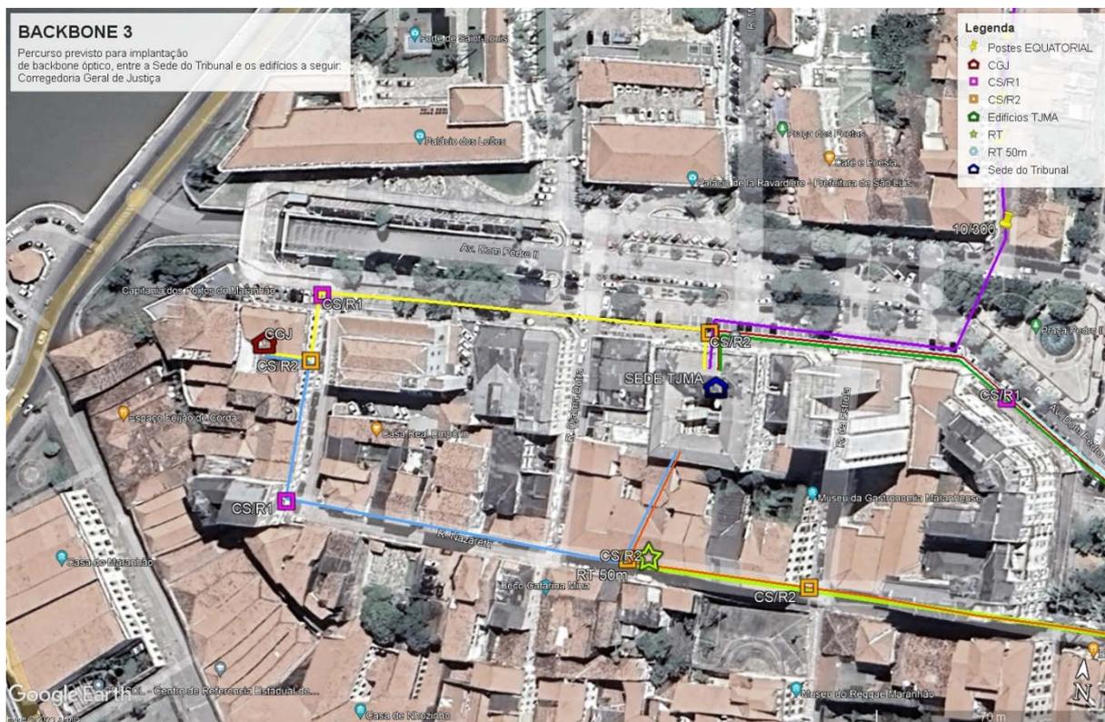
**Figura 03 – Percurso Previsto do Anel / Backbone Óptico 3. Interligando os prédios sede do TJMA e da CGJ.**
