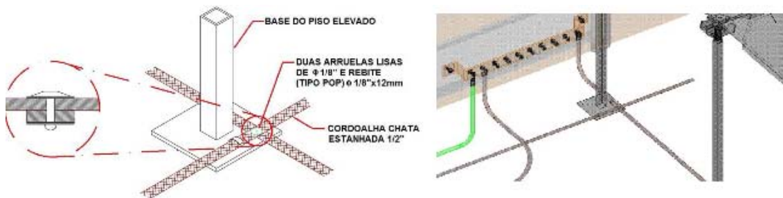
Figura 04 – Detalhe do sistema de aterramento com malha de aterramento
