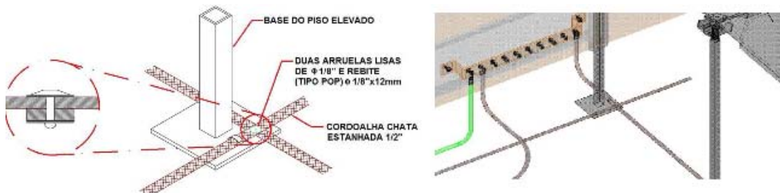
Figura 04 – Detalhe do sistema de aterramento com malha de aterramento
