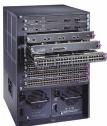
Exemplos de módulos de expansão são os módulos de aplicação (application-specific), tais como Firewall, Wireless e Network Analysis (análise de rede), assim como módulos para interfaces adicionais, fontes de alimentação, bandejas de ventilação extras (cooling fans) e assim por diante.
