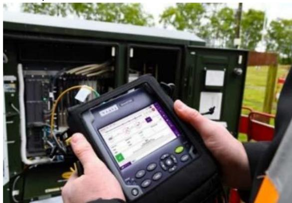
Figura 7: Certificação de fibras ópticas
