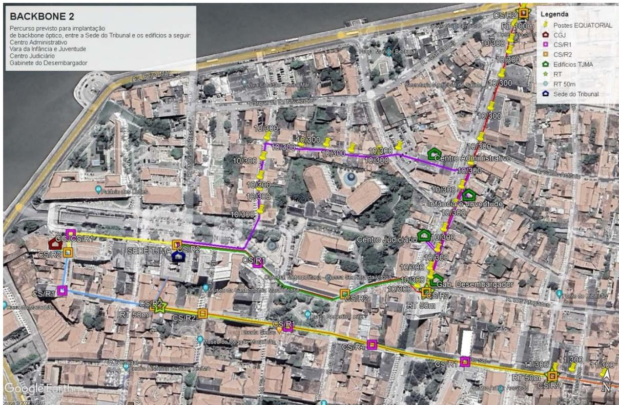
**Figura 02 – Percurso Previsto do Anel / Backbone Óptico 2. Interligando o prédio sede do TJMA e o Centro Administrativo com as Derivações.**
