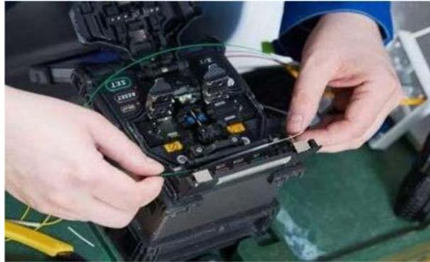
Figura 6: Fusão de fibras ópticas
